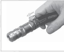
Déplacez le serre-joint par-dessus le tuyau et le pilier.
