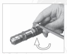
4. Tournez la vis du serre-joint à la droite et fixer le serre-joint.
