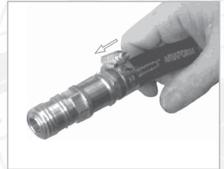
3. Schieben Sie die Klemme über der Schlauch und die Schlauchstutzen.
