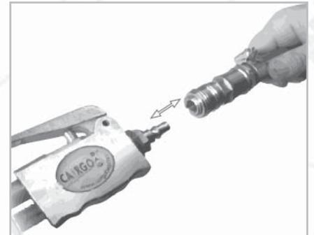
2. Drücken Sie die Anschluss Stutzen von die Luftpistole in die Kopplung. Drücken Sie diese kräftig zusammen.
