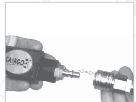
2. Stellen Sie eines die Ventilverbindungen in den Verkoppeln vom Luftpistole.
