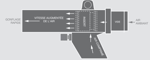
La dépression entraîne l'aspiration d'une énorme quantité d'air ambiant, ce qui pour vous, en tant qu'utilisateur, résulte de nouveau en une réduction importante de la durée nécessaire au gonflage!
